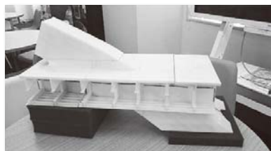
図-3 剛結部の3D模型
