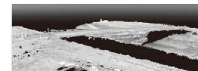
UAV点群データ(視点:側面) 図-2 UAV撮影からの点群データ化
