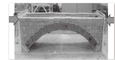
写真-2 石橋模型と拘束棒の位置
