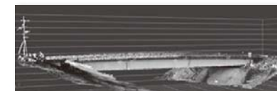
レーザ計測点群データ(視点:側面) 図-1 レーザ計測による点群データ
