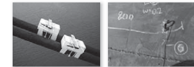
写真-2 無線センサ(右) ひび割れゲージ(左)
