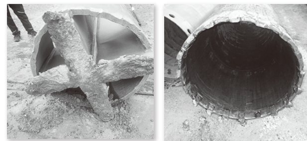
写真-7 刃先がつぶれたチゼルとケーシング
